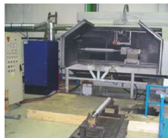
Injektorstrahlkabine mit zweifach geteilter Tür zum Strahlen von Zylinderteilen vor dem Auftrag einer Beschichtung durch Plasma
