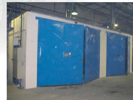
Zwei Strahlräume - jeder für einen anderen Strahlmitteltyp (innere Abmessungen 6 x 5 x 3,5 m und 6 x 4 x 3,5 m)
