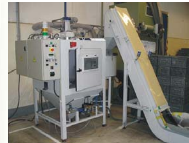
Spezielle Strahlkabinen für das Strahlen von Wälzlagering
