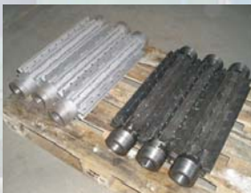
Gehärtete Rotorteile vor und nach dem Strahlen
