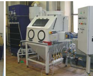
Spezielle Strahlkabinen zum Strahlen von Pressteilen aus Kunststoffen durch Kunststoffstrahlmittel
