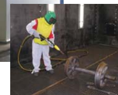
Strahlraum mit den Abmessungen 8 x 5 x 4 m mit umlaufenden Wänden und Decke aus Sandwichpaneelen, geliefert einschließlich Kompressorstation ähnlicher Konstruktion
