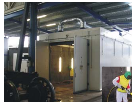
Strahlraum mit den Abmessungen 8 x 5 x 4 m mit umlaufenden Wänden und Decke aus Sandwichpaneelen, geliefert einschließlich Kompressorstation ähnlicher Konstruktion
