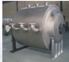
Edelstahlbehälter, gestrahlt mit Glasstrahlperlen
