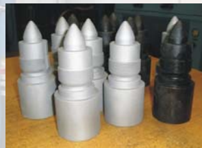
Gehärtete Teile vor und nach dem Strahlen
