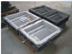
Modell für Gusstücke von Statorn von Elektromotoren vor und nach dem Strahlen
