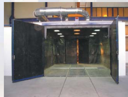
Strahlraum mit den Abmessungen 8 x 5,5 x 3,5 m, durchfahrbar mit ganzzahliger automatischer Erfassung des Strahlmittels und durch Gitter abgedeckten Fußboden
