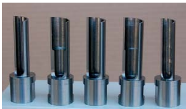
Одно- и двухрезцовые фрезы для станций очистки сварочных горелок
