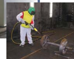
Установка струйной обработки с размерами 8 x 5 x 4 м с наружными стенами и потолком из сэндвич-панелей поставляются, включая установки сжатого воздуха соответствующей конструкции
