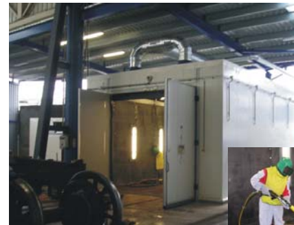
Установка струйной обработки с размерами 8 x 5 x 4 м с наружными стенами и потолком из сэндвич-панелей поставляются, включая установки сжатого воздуха соответствующей конструкции
