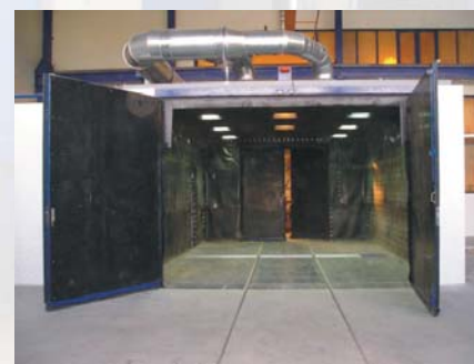
Установка струйной обработки с размерами 8 x 5,5 x 3,5 м, проездная, с системой автоматического сбора абразива и половой решеткой
