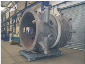
Зона плавки купольной печи
