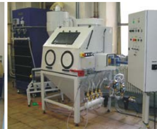
Специальная струйная кабина для обработки отливок из пластмассы с помощью пластмассового абразива
