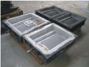
Modelos para fundición estatores de motores eléctricos, antes y después del chorro
