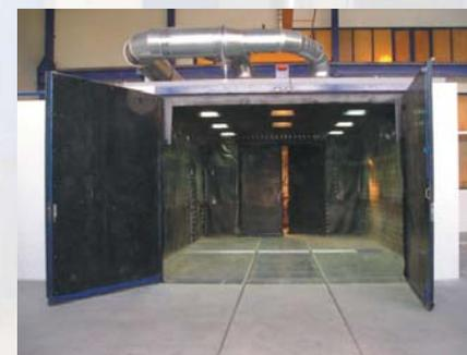
El espacio de la eyección tiene unas dimensiones de 8 x 5,5 x 3,5 m con recogida automática de los abrasivos y el suelo cubierto con rejas
