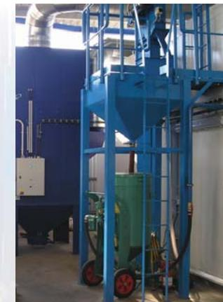
El equipamiento tecnológico del lugar donde se realiza la eyección se compone de un transportador de cubo, de un seleccionador giratorio, un tanque de abrasivos, la caldera de presión y el filtro de succión
