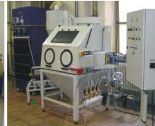
Cabina de eyección especial para eyección de prensado de sustancias plásticas con abrasivo de plástico
