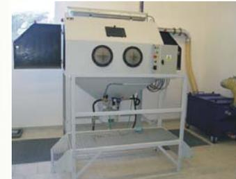
Cabina de eyección de presión con puertas lateral que se abren
