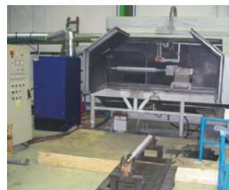
Cabina de eyección con doble puerta para la eyección de piezas cilíndricas antes de aplicar el spray de plasma
