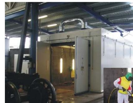
Espacio de eyección de 8 x 5 x 4 m con muros perimetrales y techo de paneles sándwich suministrados, incluyendo la cámara de compresores de diseño similar
