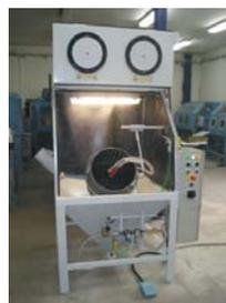
Cabina inyectora de eyección tipo TM 1000 con un tambor giratorio
