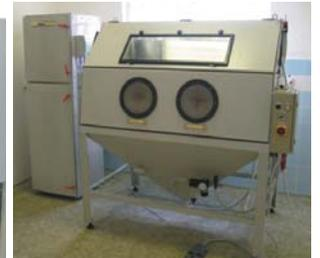
Cabina inyectora de eyección tipo TM 1500 con filtro de aspiración
