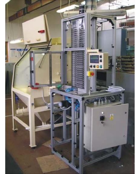
Cabina especial de eyección para la industria electrónica
