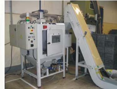
Dispositivo de eyección para los aros de rodamientos
